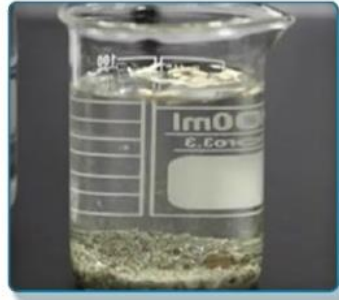
Karışım suya atıldığında talaş su üstünde yüzer.
